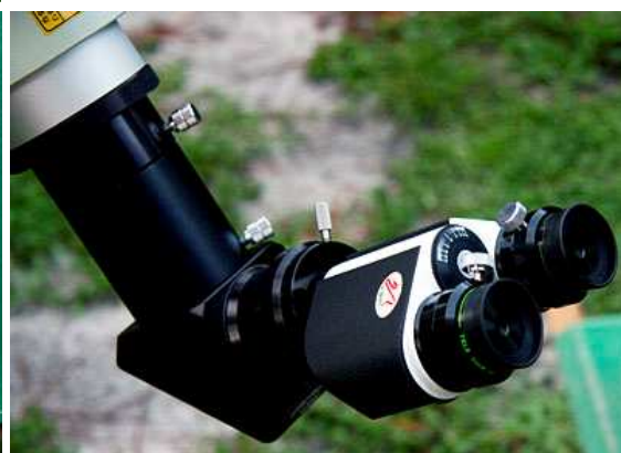
William Optics tête binoculaire sur TOA-130 avec Televue oculaires Plössl 8mm. Un 1.6X Barlow est monté sur la pièce de nez pour grossissement comparables des éléments planétaires à l'oculaire 5mm testés.
